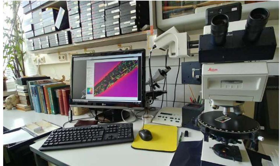
Microscopio a luce polarizzata Leica DMRXP,
