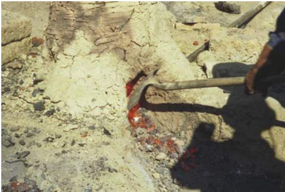
Apertura della camera del forno e fuoriuscita della scoria.
