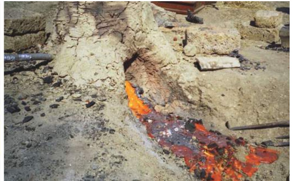
Apertura della camera del forno e fuoriuscita della scoria.
