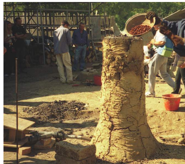
Caricamento del forno con strati alternati di materia prima (e.g., \text{Fe}_2\text{O}_3 ) e carbone di legna.
