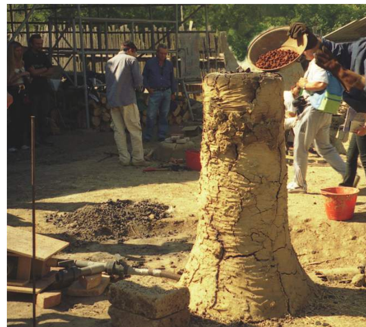
Carica del forno: strati di materia prima ( \text{Fe}_2\text{O}_3 ) e combustibile (carbone da legna)
