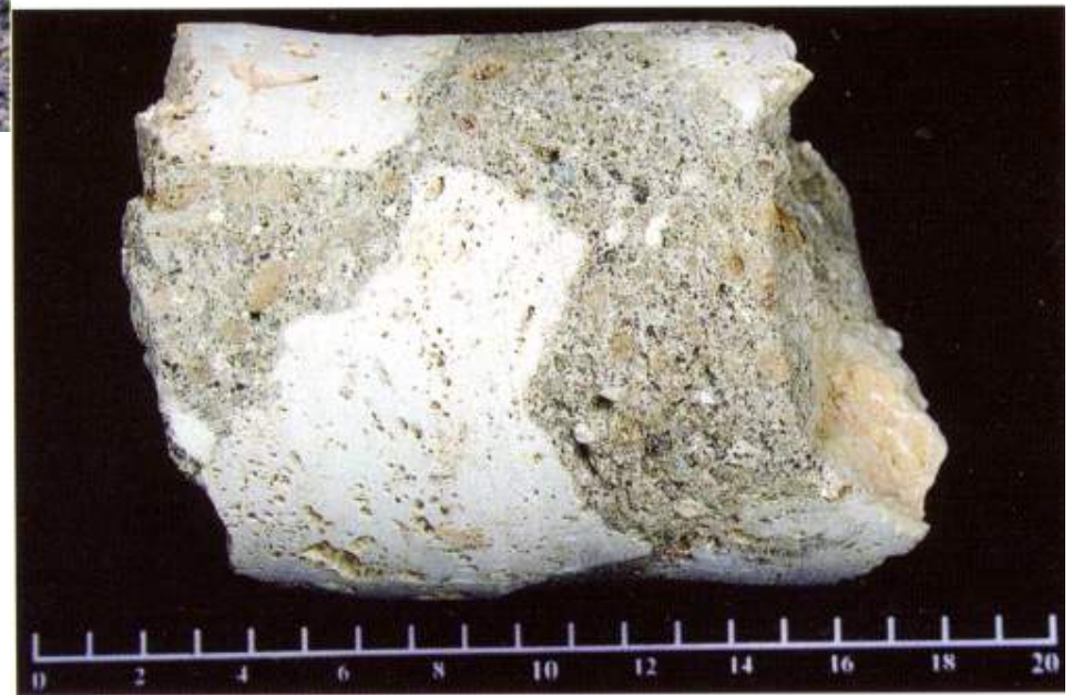
Calcestruzzo con pozzolana. Ponte di Augusto Narni - I sec a.C..
