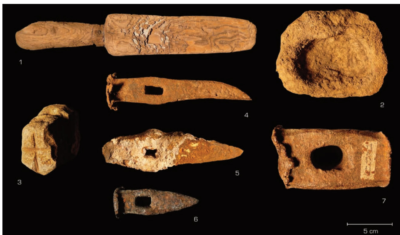
Fig. 35. Attrezzi da miniera rinvenuti all'interno delle gallerie minerarie dell'Altipiano del Calisio: 1. cuneo in legno; 2. lumino in pietra; 3. teodolite? in pietra; 4-5-6. scalpelli; 7. mazza [Collezione Miniere del Museo delle Scienze di Trento inv. MIE81, MIE69, MIE79, MIE73, MIE72, MIE76].
