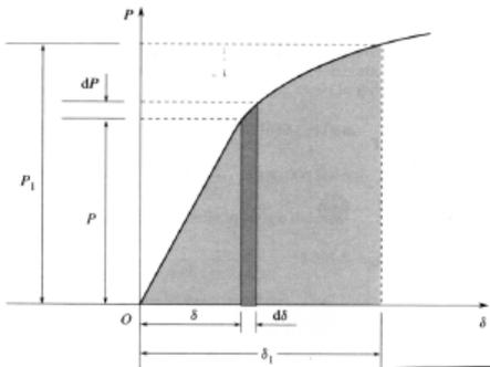
Se si riporta in un diagramma l'andamento di  $P$  in funzione di  $\delta$  si ottiene il grafico in figura. Un aumento del carico pari a  $dP$  provoca un allungamento  $d\delta$
