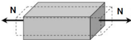
È dunque possibile calcolare una **deformazione trasversale** definita dal rapporto tra dimensione iniziale e finale della sezione in direzione perpendicolare all'asse longitudinale
