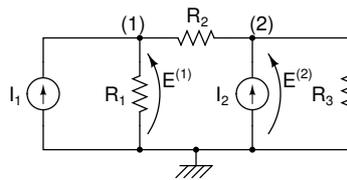
Le tensioni e le correnti su tutti i bipoli (con riferimento alla figura seguente per quanto riguarda i versi scelti) possono essere espresse tramite le due tensioni di nodo sopra considerate.
