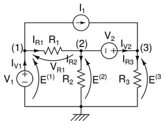
Sia il generatore di tensione  $V_1$  sia il generatore di tensione  $V_2$  impongono due vincoli alle tensioni di nodo. Il primo vincolo è dato da  $E^{(1)} = V_1$ , mentre il secondo da  $E^{(3)} = E^{(2)} + V_2$ . Delle tre tensioni di nodo, solo una è un'incognita del problema. Con queste osservazioni, si può scrivere
