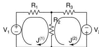
Le tensioni e le correnti su tutti i bipoli (con riferimento alla figura seguente per quanto riguarda i versi scelti) possono essere espresse tramite le due correnti di anello sopra considerate.
