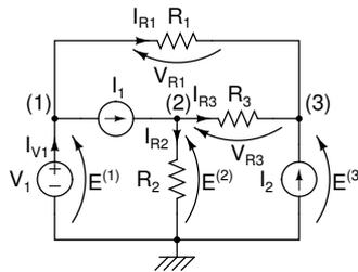
Si noti che il generatore di tensione  $V_1$  impone il vincolo  $E^{(1)} = V_1$ . La tensione  $E^{(1)}$  è quindi nota e può essere non considerata come incognita del problema. Per quanto riguarda tensione e corrente sulle resistenze si ha
