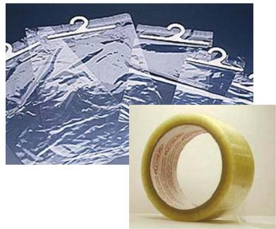
La polimerizzazione radicalica dell'etilene produce un polimero tenero e resistente, noto come polietilene a bassa densità (LDPE), caratterizzato da catene molto ramificate che impediscono un impaccamento efficiente, per cui l'LDPE è amorfo e trasparente, con punto di fusione di circa 108°C, quindi non utilizzabile con acqua bollente.
