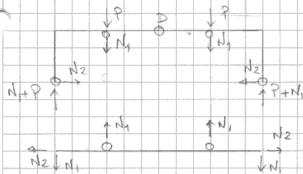
La struttura è una volta iperstatica.
