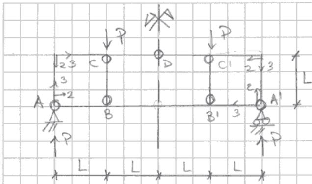
Utilizzando la simmetria del carico e tenendo conto delle azioni interne, è possibile ricondursi allo studio delle due parti diseguate.
