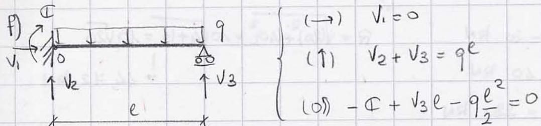
Trave una volta iperstatica (tre incognite,  $V_2$ ,  $V_3$  e  $C$ , e solo due equazioni, (↑) e (0°)).
