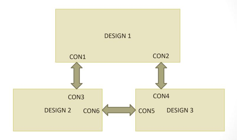
Lo schematico a blocchi, in cui ogni board è rappresentato da un PCB, permette di verificare la correttezza dei collegamenti.
