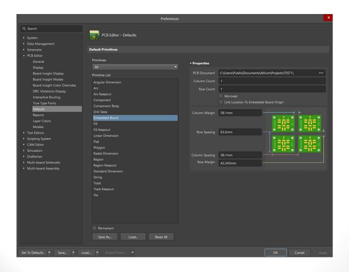
Dalla finestra Properties si possono impostare i parametri e il file PCB da replicare. Si imposta lo spazio fra righe e colonne
