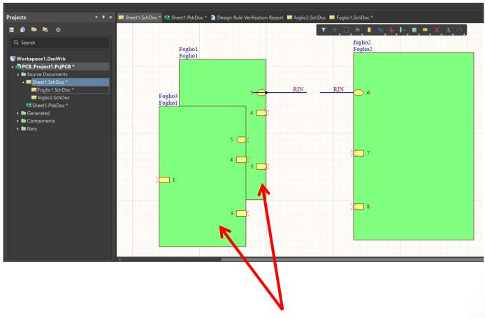
Diagramma a blocchi in cui posso inserire più copie dello stesso schematico
