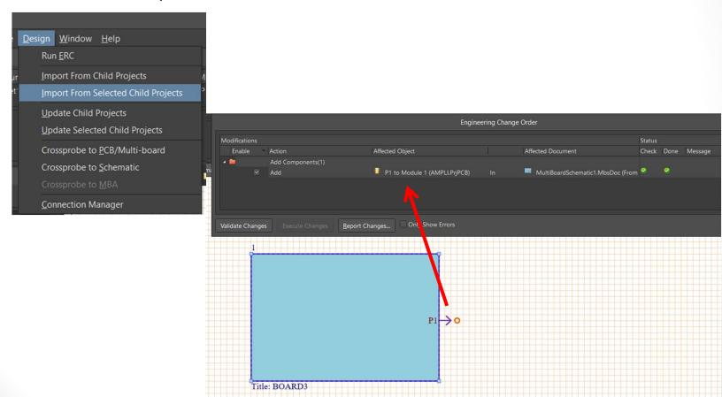
L'importazione delle caratteristiche mette a disposizione i parametri dei connettori che sono stati definiti per il livello superiore.
