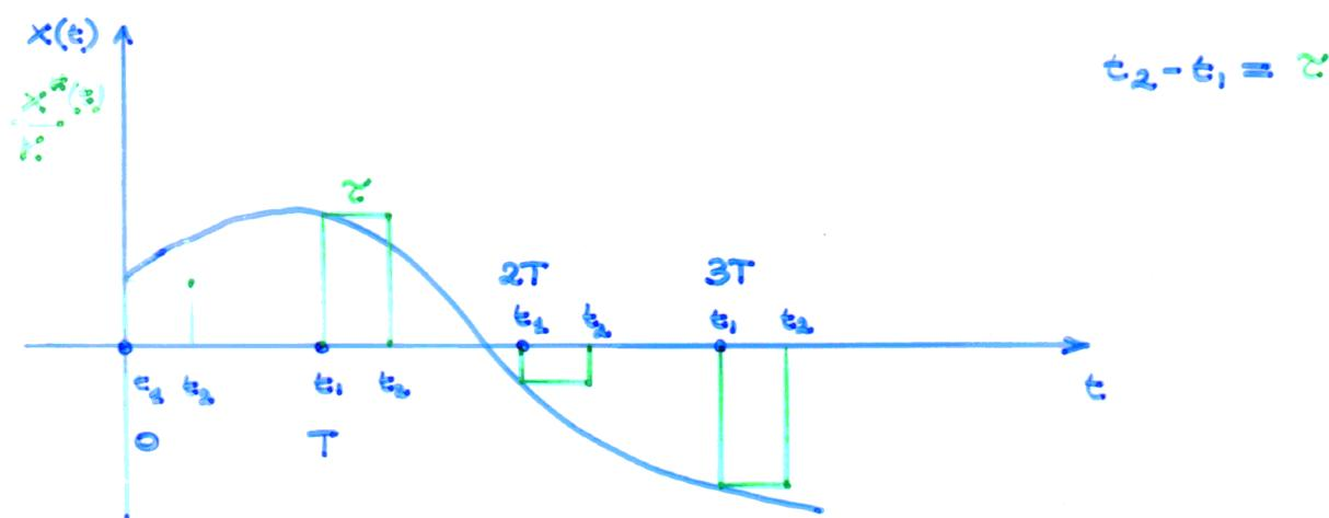
$t_1$ :  $S_1$  si chiude (per un "istante")  $\Rightarrow$  C si carica a  $x(nT)$  ( $t = nT$ )
