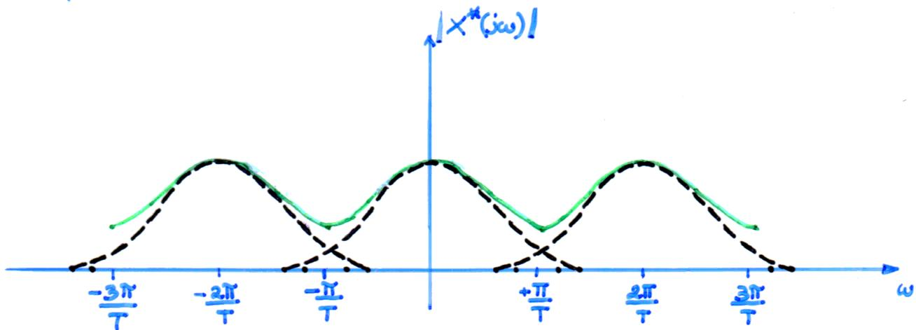
in questo caso le "code" OLTRE  $\omega_B$  di  $X(j\omega)$  si SOVRAPPONGONO nel formore  $X^*(j\omega)$   $\Rightarrow$  l'andamento di  $X^*(j\omega)$  alla pulsazione  $\omega$  dipende dall'andamento di  $X(j\omega)$  a DIVERSE PULSAZIONI: si parla di ALIASING o FOLDING (distorsione non lineare.) In questo caso NON è possibile recuperare  $x(t)$  da  $x^*(t)$  mediante il filtro di smoothing.
