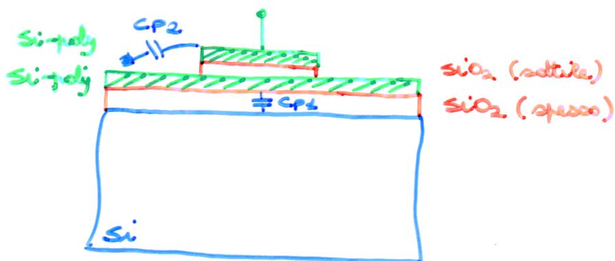
$C_{P1}$  = capacità parassita tra l'ornatura inferiore e il substrato
