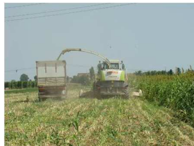
Falciatrinciamento di sorgo con trasporto su camion. Prove effettuate nell'ambito del progetto europeo LIFE – Seq-Cure anno 2008 Zona Ravenna.
