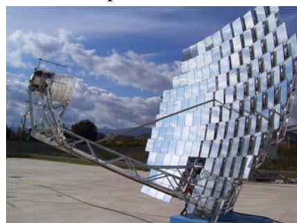
Prototipo di sistema cogenerativo solare
