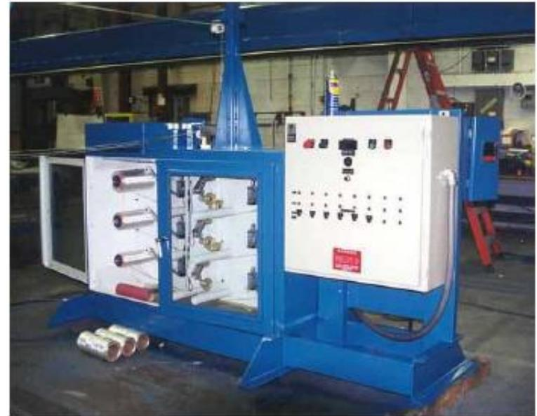
Tensionatori per pretensionamento fibre
