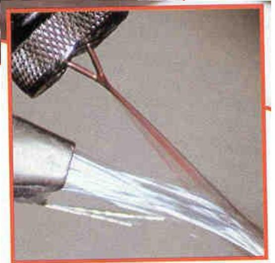
Tecnologia semi-manuale, dipendenza da operatore ma si riesce a controllare rapporto fibra-matrice
