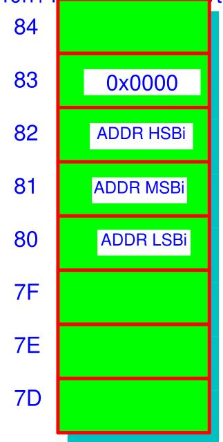
Interrupt vector posizione n. 16 Indirizzo di 4 byte di cui uno non significativo Interrupt i-esimo
