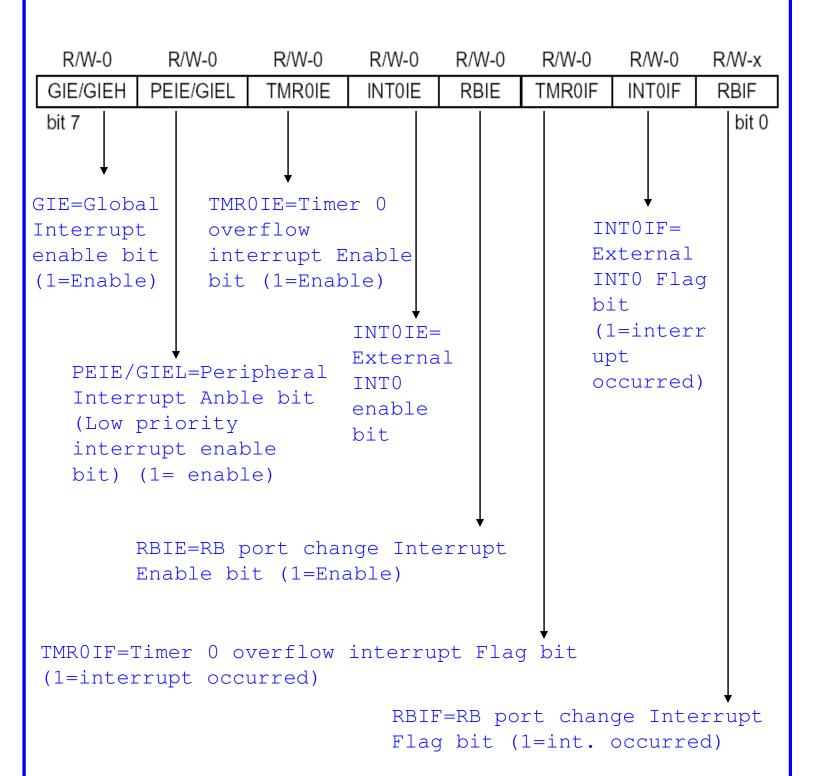
RB Interrupt sta ad indicare che viene generato un interrupt se almeno uno dei bit della porta B: RB4, RB5, RB6, RB7 ha cambiato stato (interrupt su livello).
