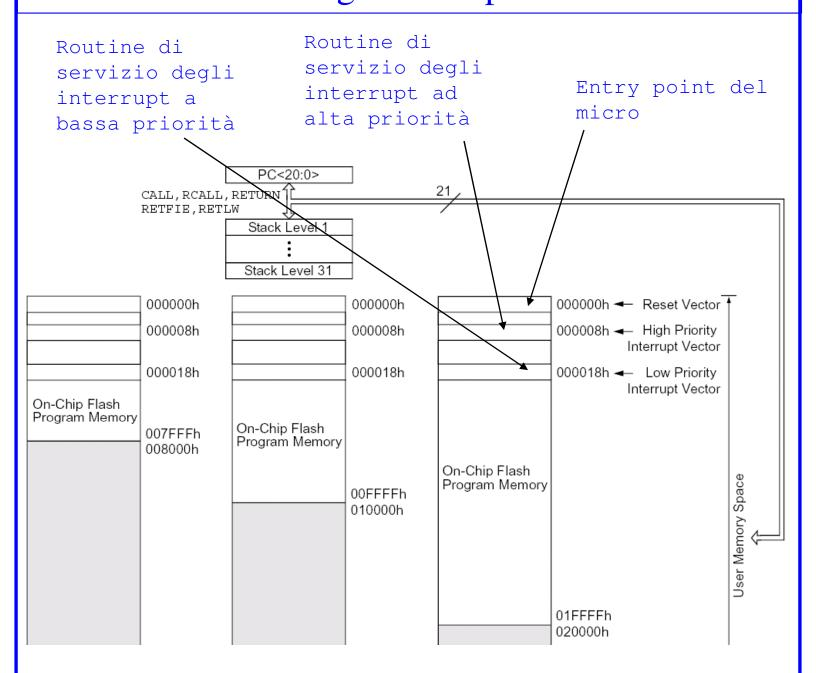
Sono indirizzi e quindi sono formati da almeno 3 byte di indirizzo e contengono il puntatore a funzione che indica l'address delle funzioni di servizio degli interrupt generate dal programmatore software e "linkate" nella flash assieme al resto del codice utente.
