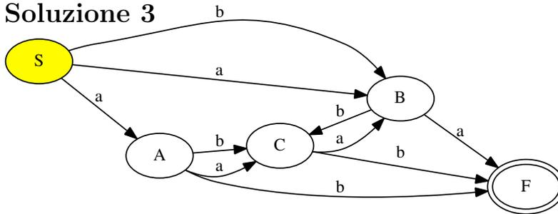
L'automa non è deterministico, come si vede dal fatto che con input  $a$  dallo stato  $S$  si può passare sia in  $A$  sia in  $B$  e con input  $b$  da  $A$  si può andare in  $C$  o in  $F$ .
