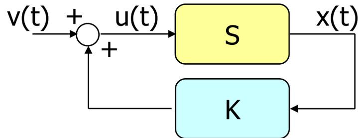
con  $\dim(K) = m \times n$ , permette di modificare arbitrariamente gli autovalori del sistema
