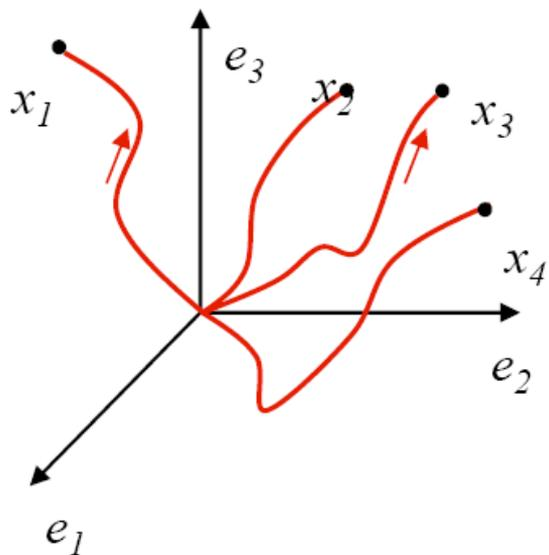
È **completamente controllabile** se  $x=0$  può essere raggiunto da qualunque stato in t finito
