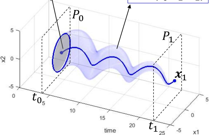
**NOTA:** per i sistemi LTI, tali proprietà non dipendono da  $t_0$  e  $t_1$  ma solo da  $t=t_1-t_0$  e si può considerare  $x = 0$  come unico punto di interesse
