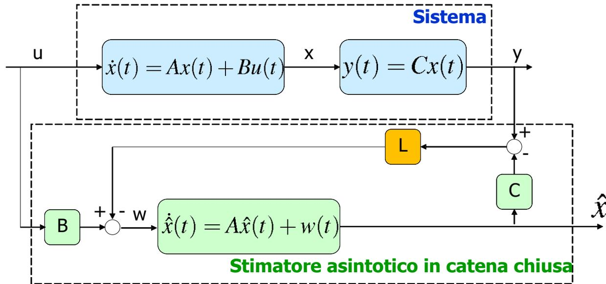
può, grazie alla proprietà di dualità, essere effettuato sfruttando i metodi di allocazione degli autovalori per il progetto di controllori con retroazione dello stato.
