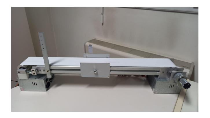
Piccolo nastro trasportatore da laboratorio (1.20 m di lunghezza) movimentato da motore DC 24V
