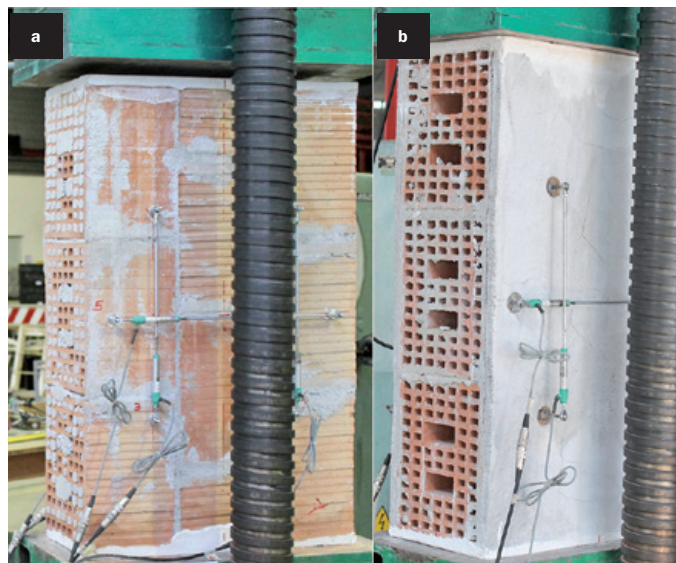
10. Prove di resistenza a compressione laterale della muratura: (a) provino senza intonaco; (b) provino con intonaco fibro-rinforzato.
