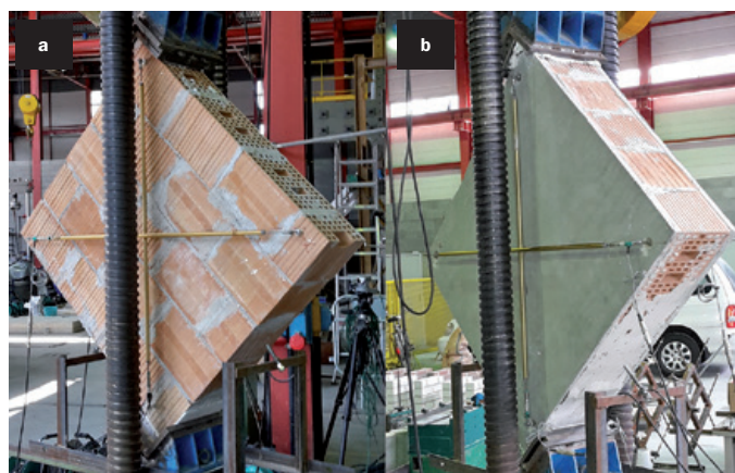
11. Prove di resistenza a compressione diagonale della muratura: (a) provino senza intonaco; (b) provino con intonaco fibro-rinforzato.
