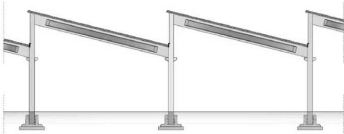
**Figura 71 - Esempio di copertura a shed con travi inclinate**
