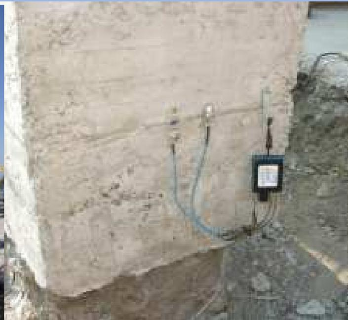
La prova consiste nel sollecitare la testa del palo mediante un maglio, di peso proporzionato al carico statico da raggiungere, in caduta libera controllata da varie altezze e nel rilevare la forza immessa e le deformazioni assiali mediante accelerometri ed estensimetri fissati sul fianco della testa palo. Si esegue sul palo pilota e non su quello in opera.
