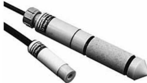
Figura 14: Piezometro elettropneumatico
