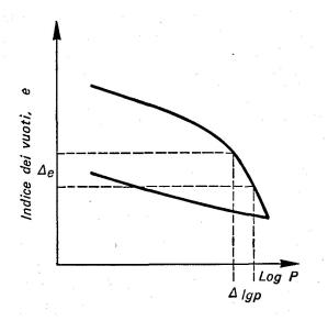
Si utilizzano successivamente i risultati delle prove edometriche significative per i vari strati e quindi il calcolo è eseguito nell'ipotesi che le <u>deformazioni del terreno avvengano solo in direzione verticale</u> senza espansioni o contrazioni orizzontali.
