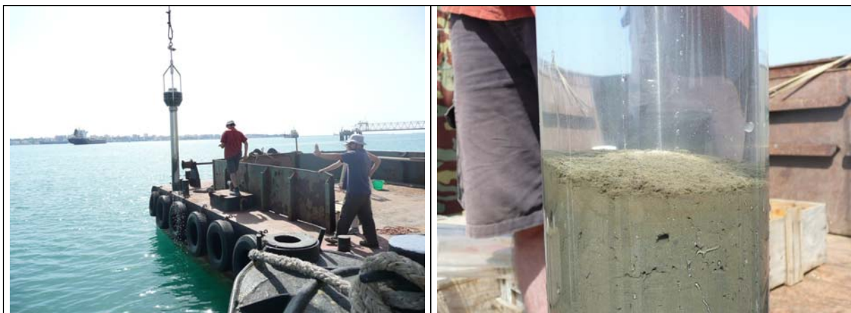
Figura 19. - Carotiere a gravità in azione.
