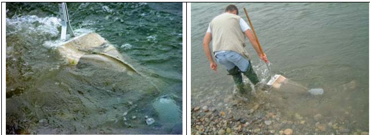
Figura 63. – Cattura di Macroinvertebrati bentonici per la misura dell'I.B.E.
