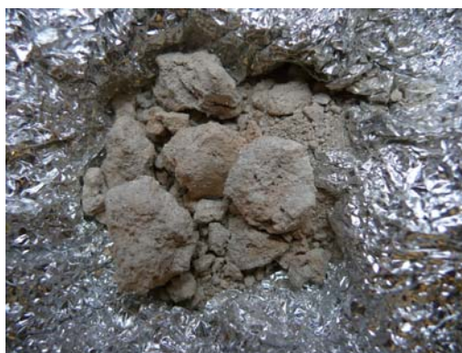
Figura 47. – Una via per il recupero dei “sedimenti”: due minuti a 550°C e perdono colore, odore e contaminanti.
