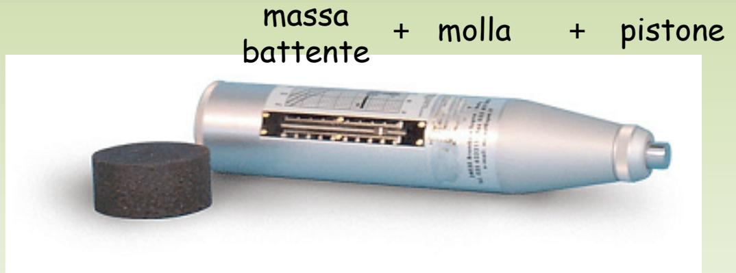
Stima della resistenza a compressione di calcestruzzo, roccia e muratura attraverso la misura dell'indice di rimbalzo **Ir** (indice di durezza superficiale)
