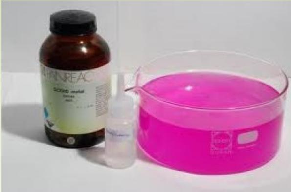
Con il tempo, l'anidride carbonica dell'aria reagisce con la calce libera riducendo il pH. Si scioglie il film passivante e si innescano processi di corrosione che portano alla ruggine.
