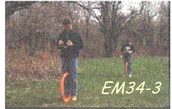
La profondità di esplorazione in questo tipo di indagini è funzione sia dello spazio tra le bobine, (m-decine di metri), sia della frequenza utilizzata, sia della disposizione delle bobine
