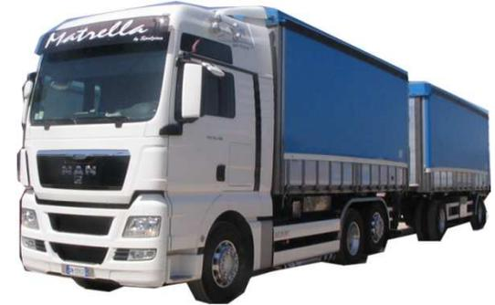
Il passaggio REALE di un mezzo a 4 assi, due dei quali in tandem, del peso complessivo di 425 kN (75+110+120+120) può essere assimilato al transito VIRTUALE di 11.98 (0.7+3.42+7.86) E.S.A. (81.6 kN)
