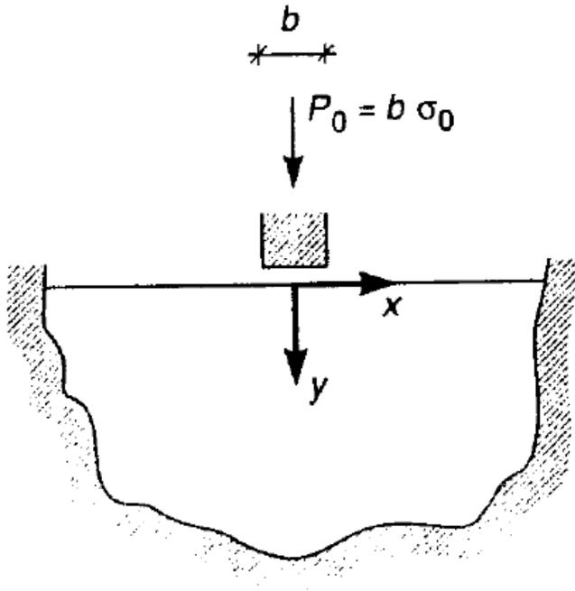
**Solido ovunque rigidamente vincolato tranne sul bordo rettilineo . Su una porzione piccola di esso di ampiezza  $b$  agisce un punzone, che trasmette una forza per unità di spessore pari a  $P=b\sigma_0$  . Il punzone è liscio, trasmette solo forze normali
