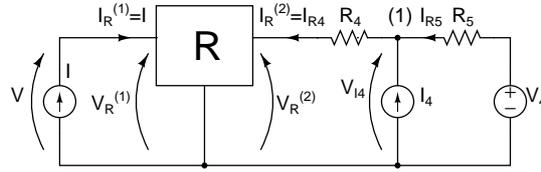
Si indichino con  $V_R^{(1)}$  e  $I_R^{(1)}$  la tensione e la corrente alla porta 1 di  $R$ , e con  $V_R^{(2)}$  e  $I_R^{(2)}$  tensione e corrente alla porta 2, con  $I_R^{(1)} = I$ ,  $I_R^{(2)} = I_{R4}$  e (usando l'equazione della matrice  $\underline{R}$  trovata al punto precedente)  $V_R^{(2)} = R_{12}I$ .
