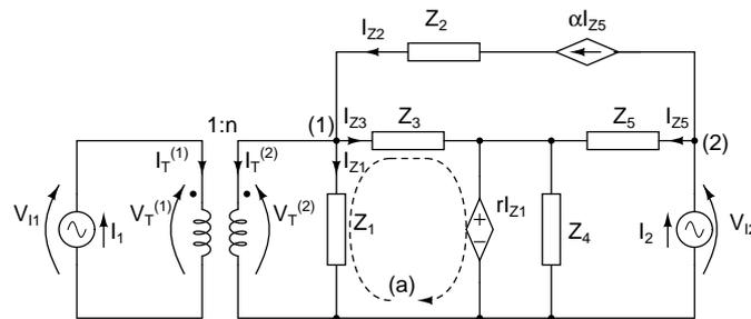
con  $Z_1 = 200 \Omega - 200j \Omega$ ,  $Z_2 = -500j \Omega$ ,  $Z_3 = 200 \Omega + 200j \Omega$ ,  $Z_4 = -100j \Omega$ ,  $Z_5 = 600j \Omega$ ,
