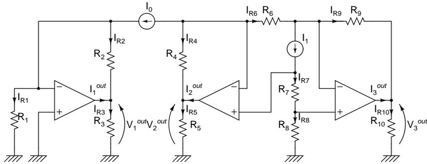
Con riferimento al circuito di figura si assumano i seguenti valori:  $R_1 = R_2 = \dots = R_{10} = 1\text{ k}\Omega$ ,  $I_0 = 2\text{ mA}$ ,  $I_1 = 1\text{ mA}$ . Si supponga inoltre che gli amplificatori operazionali siano ideali e che lavorino sempre nella zona ad alto guadagno. Calcolare le tensioni di uscita  $V_1^{out}$ ,  $V_2^{out}$  e  $V_3^{out}$ , e le correnti di uscita  $I_1^{out}$ ,  $I_2^{out}$  e  $I_3^{out}$  dei tre amplificatori operazionali.
