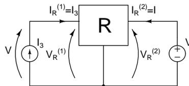
dove si collegato un generatore ideale di tensione  $V$  per calcolarne la corrente  $I$ . Usando l'equazione della matrice  $\underline{R}$  si ha
