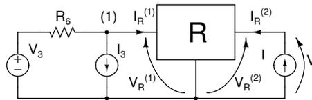
Si indichino con  $V_R^{(1)}$  e  $I_R^{(1)}$  la tensione e la corrente alla porta 1 di  $\underline{R}$ , e con  $V_R^{(2)}$  e  $I_R^{(2)}$  tensione e corrente alla porta 2, con  $V_R^{(2)} = V$  e  $I_R^{(2)} = I$ . Dalla seconda delle equazioni costitutive di  $\underline{R}$  si ha
