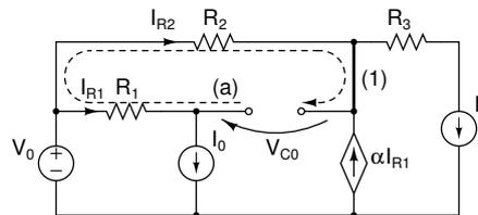
Per determinare la tensione iniziale  $V_{C0}$  si può osservare che dalla maglia (a) si ha
