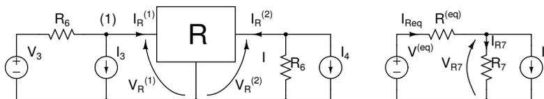
Avendo già determinato l'equivalente di Thevenin del circuito formato da  $\underline{R}$ ,  $V_3$ ,  $I_3$  e  $R_6$ , conviene per la determinazione del valore di  $I_4$  considerare il circuito di destra. Se  $P_{R7} = 0 \text{ W}$  allora sia  $I_{R7} = 0 \text{ A}$  e  $V_{R7} = 0 \text{ V}$ ; dunque
