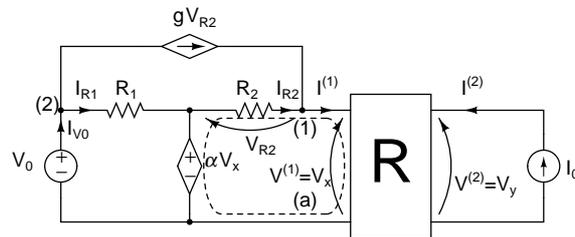
Se indichiamo con  $V^{(1)}$  e  $I^{(1)}$  e con  $V^{(2)}$  e  $I^{(2)}$  la tensione e la corrente della porta, rispettivamente, di sinistra e di destra di  $R$ , abbiamo che  $V^{(1)} = V_x$ ,  $V^{(2)} = V_y$  e  $I^{(2)} = I_0$ .
