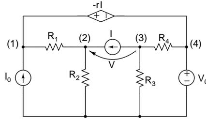
Il circuito presenta 4 nodi, numerati da (1) a (4) in figura. La tensione  $V^{(4)}$  al nodo (4) è fissata, e vale  $V^{(4)} = V_0$ ; anche la tensione al nodo (1) è fissa e vale  $V^{(1)} = V_0 - rI$ . Per trovare le tensioni  $V^{(2)}$  e  $V^{(3)}$  è sufficiente risolvere separatamente le equazioni di bilancio delle correnti, rispettivamente, ai nodi (2) e (3). Per il nodo (2) si ha
