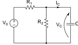
La tensione  $V_C^0$  sulla capacità è data da  $V_C^0 = \frac{R_2}{R_1 + R_2} V_0 = 3 \text{ V}$ .
