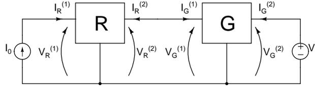
Indicando con  $V_R^{(1)}$  e  $I_R^{(1)}$  la tensione e la corrente alla porta 1 di  $R$ , e con  $V_R^{(2)}$  e  $I_R^{(2)}$  tensione e corrente alla porta 2, la potenza dissipata da  $R$  è data da
