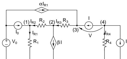
dove, poiché  $I_C = -I$ , il generatore di corrente controllato  $\beta I_C$  è stato sostituito dal generatore di corrente controllato  $\beta I$  con verso opposto.
