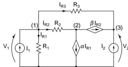
Considerando  $I_{R1}$ ,  $I_{R2}$  e  $I_{R3}$  le tre incognite del sistema, è sufficiente considerare il bilancio delle correnti ai nodi indicati con (1), (2) e (3) per risolvere il circuito.
