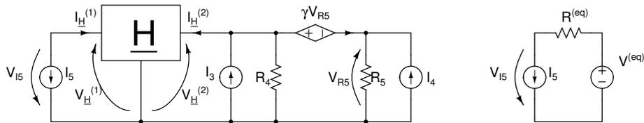
Si chiede di calcolare la potenza  $P_H$  dissipata da  $H$ , definita come
