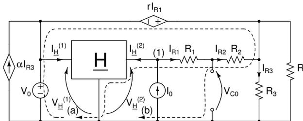
Si indichino con  $V_H^{(1)}$  e  $I_H^{(1)}$  tensione e corrente alla porta 1 di  $\underline{H}$ , e con  $V_H^{(2)}$  e  $I_H^{(2)}$  tensione e corrente alla porta 2. Osservazione dimensionalmente i termini della matrice  $\underline{H}$ , è facile ricavare quali siano le sue equazioni costitutive:
