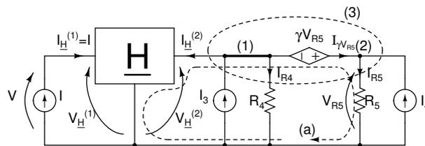
Indicando con  $V_{\underline{H}}^{(1)}$  e  $I_{\underline{H}}^{(1)}$  la tensione e la corrente alla porta 1 di  $\underline{H}$ , e con  $V_{\underline{H}}^{(2)}$  e  $I_{\underline{H}}^{(2)}$  tensione e corrente alla porta 2, si ha  $V_{\underline{H}}^{(1)} = V$  e  $I_{\underline{H}}^{(1)} = I$ .
