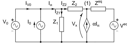
Si osservi che  $I_{V0} = I_\alpha - I_0$ ,  $I_\alpha = I_{Z1} + I_{Z2} = \frac{V_0}{Z_1} + \frac{V_0 - V_x}{Z_2}$ . Con il bilancio delle correnti al nodo (1) è possibile trovare  $V_x$
