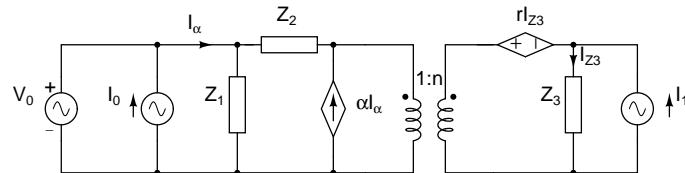
con  $Z_1 = 200j \Omega$ ,  $Z_2 = 200 + 200j \Omega$ ,  $Z_3 = (10 - 20j) \cdot 10^3 \Omega$ ,  $V_0 = 2 \text{ V}$ ,  $I_0 = -6j \cdot 10^{-3} \text{ A}$ ,  $I_1 = j \cdot 10^{-3} \text{ A}$ .
