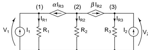
Considerando  $I_{R1}$ ,  $I_{R2}$  e  $I_{R3}$  le tre incognite del sistema, è sufficiente considerare il bilancio delle correnti ai nodi indicati con (1), (2) e (3) per risolvere il circuito.
