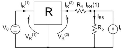
Si indichi con  $V_R^{(1)}$  e  $I_R^{(1)}$  la tensione e la corrente alla porta 1 di  $R$ , e con  $V_R^{(2)}$  e  $I_R^{(2)}$  tensione e corrente alla porta 2. Ricordando che dall'equazione costitutiva di  $R$  si ha  $V_R^{(2)} = R_{22} I_R^{(2)}$ , si ha che la potenza dissipata da  $R$  è data da
