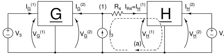
L'esercizio chiede di calcolare la potenza  $P_{\underline{G}}$  dissipata dal doppio bipolo  $\underline{G}$  e la potenza  $P_{\underline{H}}$  dissipata dal doppio bipolo  $\underline{H}$ , definite come
