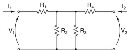
Per doppio bipolo sopra rappresentato è semplice calcolare la descrizione tramite matrice resistenza
