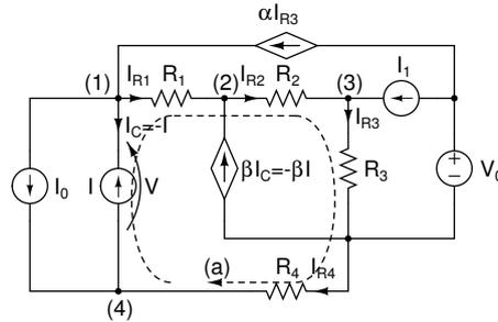
Poiché  $I = -I_C$ , il generatore di corrente comandato  $\beta I_C$  può essere sostituito da un generatore comandato  $-\beta I$ , o equivalentemente, da un generatore  $\beta I$  con verso opposto. La soluzione del circuito è ottenibile in modo molto simile al caso precedente, considerando il bilancio delle correnti ai vari nodi e infine il bilancio delle tensioni alla maglia (a).
