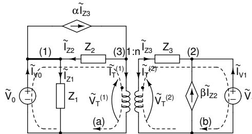
Il circuito da considerare è quello in figura. Si noti che per coerenza con il cambio di notazione, il generatore di corrente comandato  $\alpha I_{R3}$  è stato sostituito con un generatore comandato  $\alpha \tilde{I}_{Z3}$ , ed il generatore  $\beta I_{L2}$  è stato sostituito con un generatore comandato  $\beta \tilde{I}_{Z2}$ .
