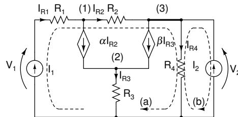
La corrente  $I_{R1}$  è data da  $I_{R1} = I_1$ . La corrente  $I_{R2}$  si può ricavare dal bilancio delle correnti al nodo (1)
