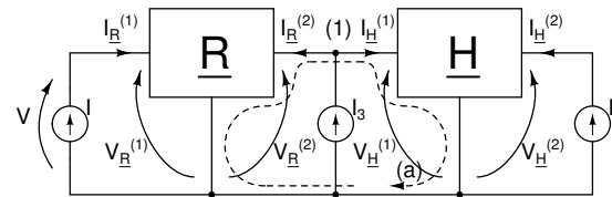
Si indichino con  $V_{\underline{R}}^{(1)}$  e  $I_{\underline{R}}^{(1)}$  la tensione e la corrente alla porta 1 di  $\underline{R}$ , e con  $V_{\underline{R}}^{(2)}$  e  $I_{\underline{R}}^{(2)}$  tensione e corrente alla porta 2. Siano inoltre  $V_{\underline{H}}^{(1)}$  e  $I_{\underline{H}}^{(1)}$  la tensione e la corrente alla porta 1 di  $\underline{H}$ , e  $V_{\underline{H}}^{(2)}$  e  $I_{\underline{H}}^{(2)}$  tensione e corrente alla porta 2.
