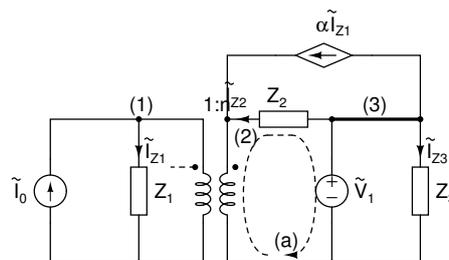
Si consideri il circuito di figura, in cui per coerenza con il cambio di notazione, il generatore di corrente comandato  $\alpha I_{L1}$  è stato sostituito con un generatore comandato  $\alpha \tilde{I}_{Z1}$ .
