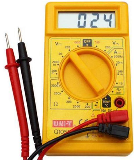
*Come usare il multimetro per misurare un valore di tensione* – Si utilizzano i puntali collegati alle borchie V (rossa) e COM (nera) per collegare il multimetro *in parallelo* al componente di cui si vuole misurare la tensione. La tensione misurata è positiva o negativa dipendentemente se concorde o discorde da quella indicata nella freccia.
