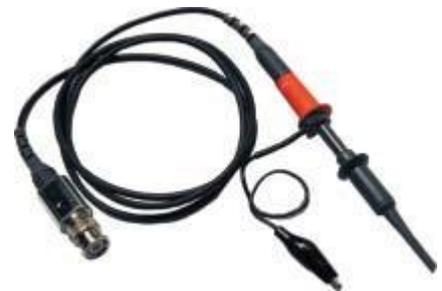
**ATTENZIONE:** per questo motivo, è necessario che, nel caso in cui si utilizzino due o più sonde contemporaneamente, che le loro masse (i coccodrilli) siano collegate allo stesso nodo del circuito.
