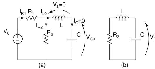
Per  $t < t_0 = 0$  s il circuito da considerare è quello indicato con (a), con l'ipotesi che sia la capacità sia a regime (ovvero  $I_C = 0$ ) sia l'induttore sia a regime (ovvero  $V_L = 0$ ) da cui si ha
