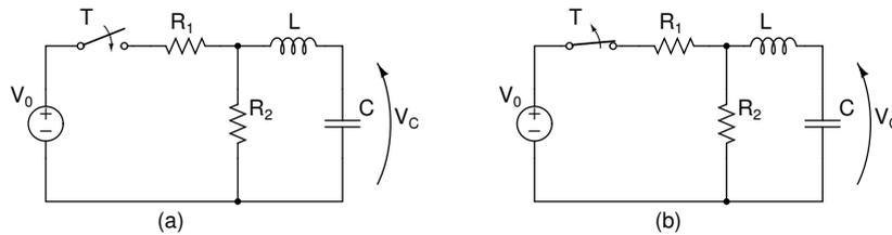
Con riferimento al circuito di figura, si assumano i seguenti valori:  $R_1 = R_2 = 1 \text{ k}\Omega$ ,  $C = 0.1 \mu\text{F}$ ,  $L = 0.5 \mu\text{H}$ ,  $V_0 = 5 \text{ V}$ . Si supponga che per  $t < t_0 = 0 \text{ sec}$  il circuito sia a regime.
