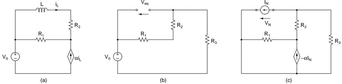
Per  $t \leq 0$  sec il circuito è a regime e l'induttore si comporta come un cortocircuito; la situazione è mostrata in figura (a). Applicando la ripartizione di corrente, si può scrivere  $i_L = -(\alpha i_L) \frac{R_1}{R_1 + R_2}$  da cui segue immediatamente  $i_L = 0$  per cui  $i_L(t) = 0, \forall t \in (-\infty, 0)$ .
