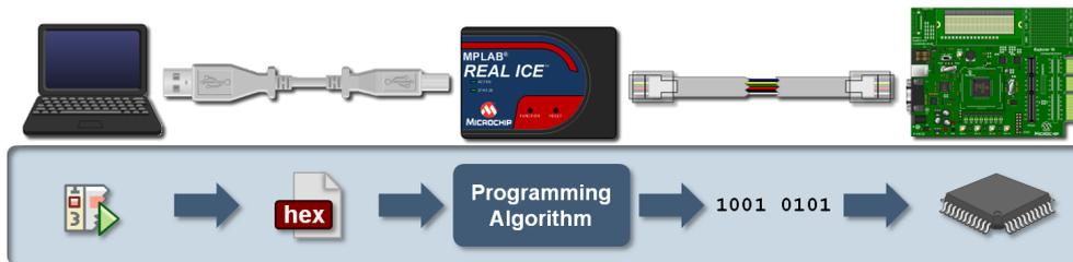
Figura B.2.24: In-Circuit Programmer/Debugger: principio di funzionamento
