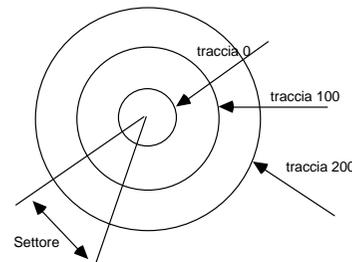
Ogni **blocco** del disco è identificato con la terna **<superficie, traccia, settore>**
