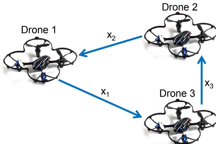
Al fine di mantenere un moto coordinato della flotta, ogni drone è programmato per regolare la propria velocità in funzione della distanza con l'altro drone del quale riceve la posizione via rete wireless, più un eventuale comando esterno fornito dal supervisore centralizzato. Considerando per semplicità la posizione del drone come una variabile scalare, indicata con  $X_i$ , le equazioni differenziali che descrivono il moto della flotta di tre droni sono esprimibili come segue:
