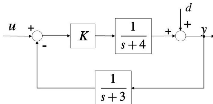
si determini il valore di  $K$  tale per cui  $y(t) \rightarrow 0,1$  per  $t \rightarrow \infty$ , imponendo  $u(t) = 0$  ed applicando un gradino unitario al segnale  $d(t)$  (cioè:  $D(s) = 1 / s$ ).
