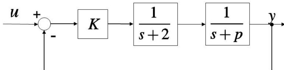
si progettino i valori di  $K$  e  $p$  in modo che il sistema in retroazione abbia tempo di assestamento  $T_a = 3$  secondi e coefficiente di smorzamento  $\delta = 0,1$
