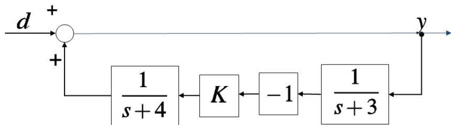
Si noti che il nodo sommatore a sinistra nel diagramma iniziale è stato sostituito con il blocco  $-1$  nel ramo di retroazione, perciò di fatto si tratta ancora di un anello con retroazione negativa. Risolvendo l'anello per ottenere la funzione di trasferimento  $G_{cl}(s)$ , applicando il teorema del valore finale al segnale  $Y(s) = G_{cl}(s) D(s)$  ed imponendo il vincolo fornito dal testo si ottiene:
