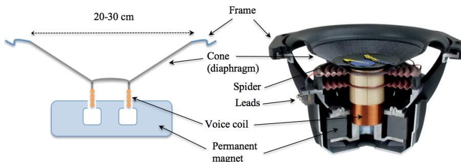
Tale dispositivo è un sistema elettromeccanico che può essere schematizzato dal diagramma seguente, che evidenzia la presenza di un circuito elettrico RL e di un gruppo massa-molla-smorzatore azionato dalla forza di attrazione magnetica  $F_L$ :
