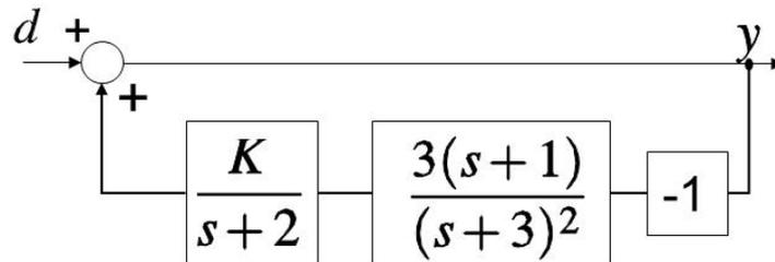
Si noti che questo schema ha retroazione positiva, ma è presente un blocco con funzione di trasferimento  $-1$  (necessario per mantenere la coerenza con il segno della retroazione nello schema originario).
