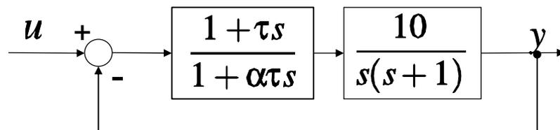
e si progettino i parametri del controllore  $\alpha$  e  $\tau$  in modo tale che lo zero del controllore “cancelli” (i.e. si semplifichi con) uno dei poli del sistema controllato ed il sistema chiuso in retroazione risulti avere coefficiente di smorzamento  $\delta = 0,5 = 1/2$ .
