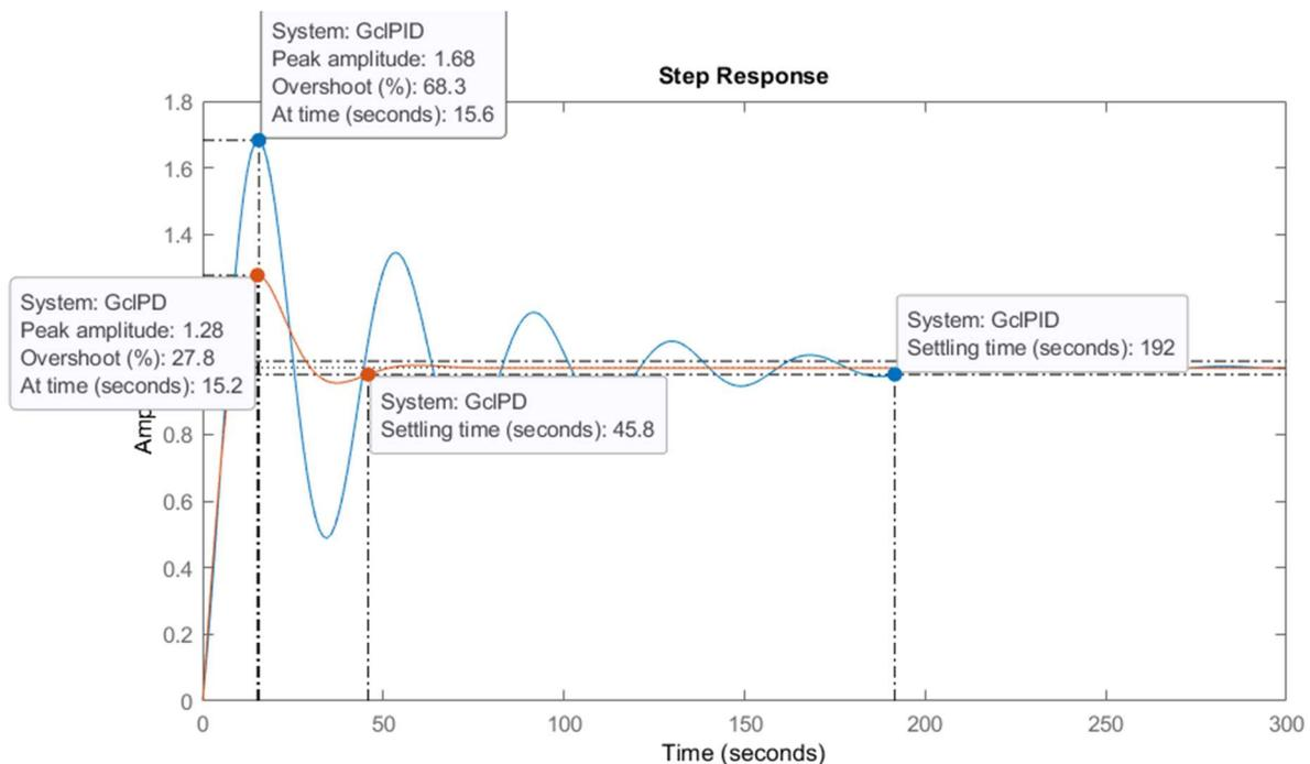
% Il PD fornisce una prestazione migliore in assoluto, cioè sia in termini di tempo di assestamento che di overshoot, entrambi minori di quelli ottenuti con il PID
