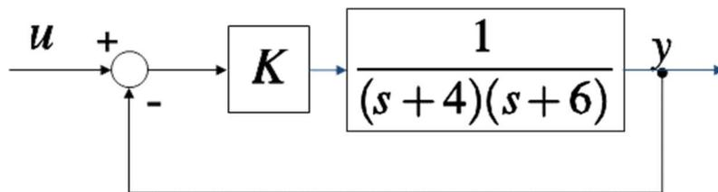
si progetti il valore di  $K (>0)$  in modo che il sistema ad anello chiuso abbia due poli entrambi pari a  $-p$ , calcolando anche il valore di  $p(>0)$ .
