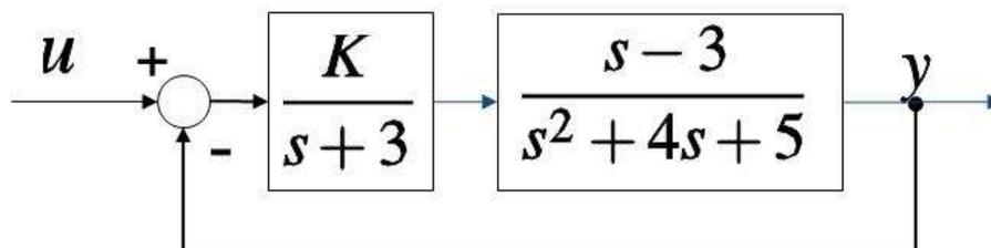
si determini il valore di  $K > 0$  per cui il sistema risulti semplicemente stabile. Si specifichi inoltre se per tale valore di  $K$  il sistema risulti avere un polo nullo oppure una coppia di poli puramente immaginari (senza necessariamente calcolarli).
