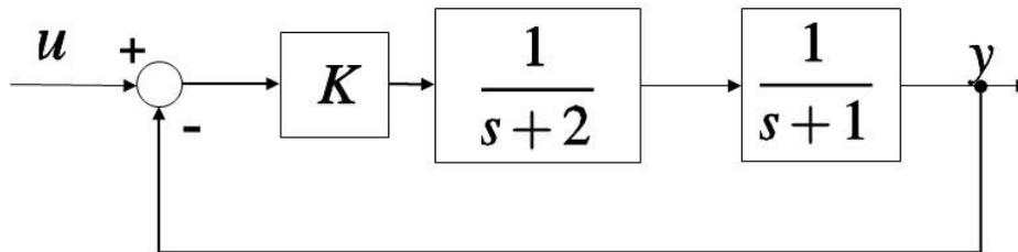
si progetti il valore di  $K$  in modo che il sistema in retroazione abbia un coefficiente di smorzamento  $\delta = 0, m_1$  (o equivalentemente  $m_1/10$ )
